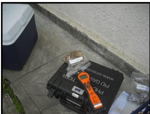
Foto 5: Medição de voláteis com PID
