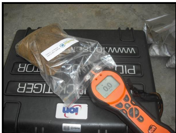
Foto 3: Medição de voláteis com PID
